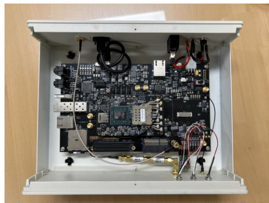
FPGA 기반 실시간 GNSS 신호 생성기 하드웨어 구성
