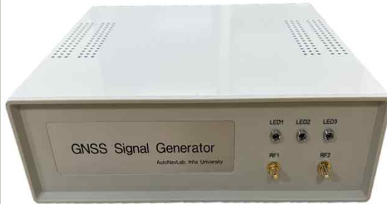
FPGA 기반 실시간 GNSS 신호 생성기 하드웨어 구성
